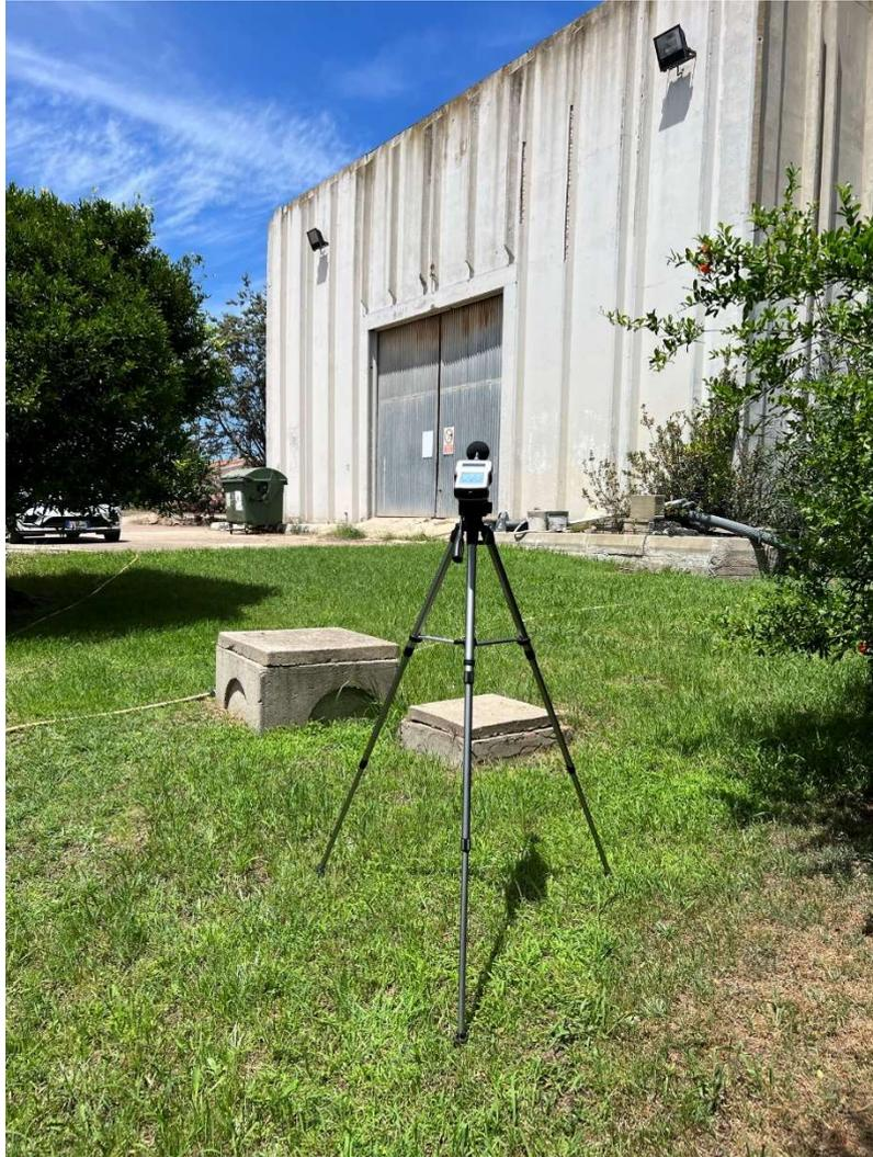
*Rilevo fonometrico relativo al punto di misura A<sub>1</sub>*
